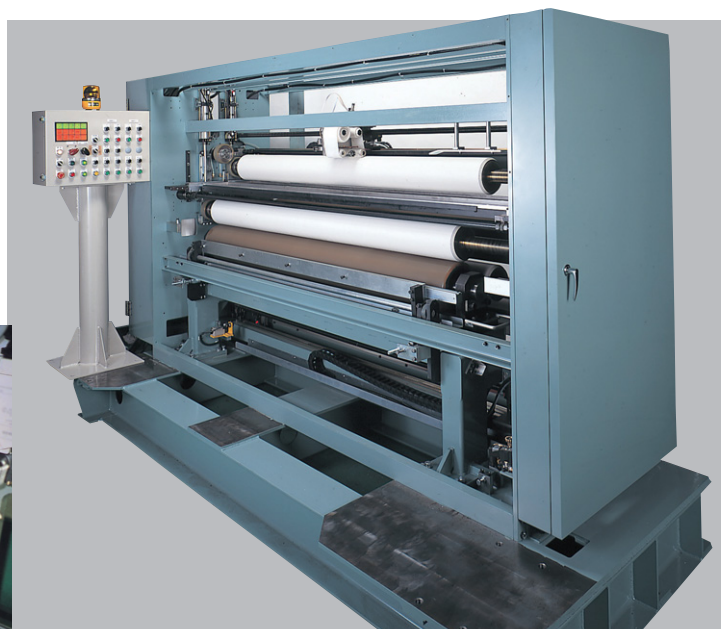
ステンレス鋼板テンションレベラー用ダストハンター
