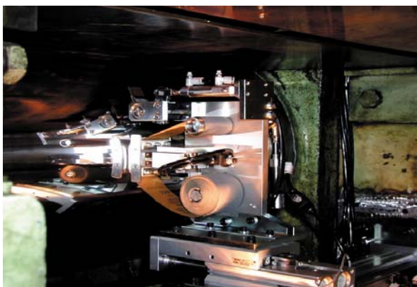
銅箔圧延工程の鏡面ローラ自動洗浄
